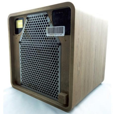
Une solide grille de protection avec quelques traces de colle pour la fixation de la mousse.
