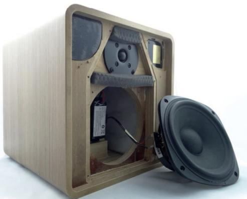
Face avant démontée : accès de la batterie par l'arrière du HP et antennes.
