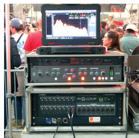
Régie minimaliste avec une CL5 et son Rio local, plus un périph SSL Fusion pour donner du grain au mixage. Côté dB(C), on atteint des valeurs qui causent !
