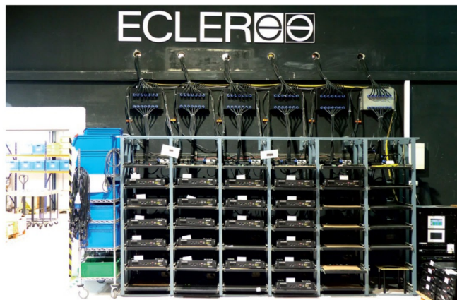
Autre niveau de contrôle qualité, les amplis sont reliés à des charges et fonctionnent à plein régime pendant 24 heures. Ce test, réalisée sur 100 % des produits, permet de détecter ce qu'Ecler appelle la « mortalité infantile » des composants. Réalisé sur un échantillon de produits, un ultime contrôle de qualité se déroule sur une table de vibrations qui simule les sollicitations dues au transport du matériel.
