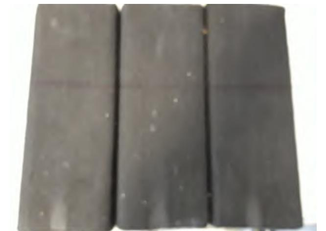
Aspecto de la muestra tras del ensayo de inflamabilidad según EN ISO 11925-2 (aplicado en borde)
