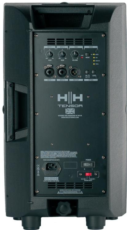
L'absence de ventilation forcée évite le bruit parasite du ventilateur, mais la présence d'aérations en haut et en bas de l'enceinte laisse entrer la poussière à l'intérieur.
