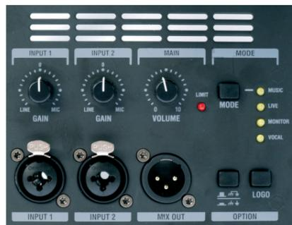
Simplicité, efficacité. Le raccordement d'une source de type micro ou ligne ne nécessite pas d'utiliser un switch, ce qui est parfois source d'erreurs pour les « novices ». C'est le potentiomètre rotatif de l'entrée qui permet pour la première moitié de sa course de régler le niveau ligne, et au-delà de 12 heures, applique le gain microphonique.
