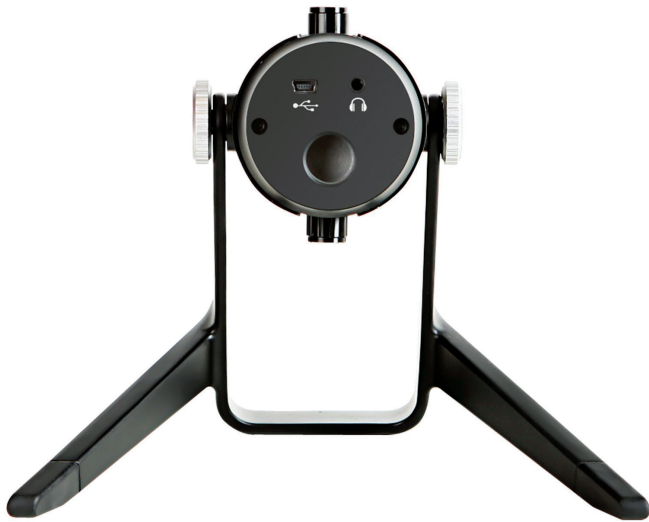
Le dessous du micro héberge la connectique (prises USB et casque 3,5 mm), ainsi qu'un taraudage fileté permettant de le fixer sur un pied standard.
