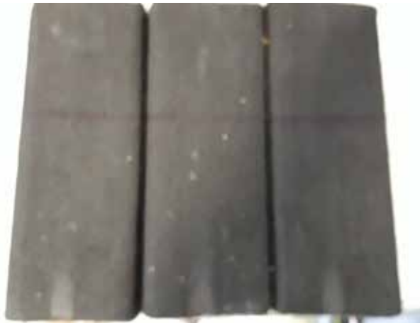
Aspecto de la muestra tras del ensayo de inflamabilidad según EN ISO 11925-2 (aplicado en borde)
