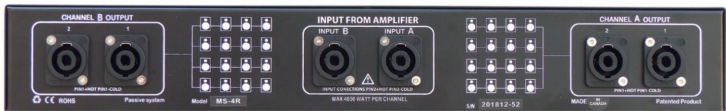
Entrées et sorties sur Speakon, mais pas avec le même brochage. 2+ et 2- pour les entrées, 1+ et 1- en sortie. L'idée du fabricant est de se prémunir d'une confusion entre les entrées et sorties de l'interface.
