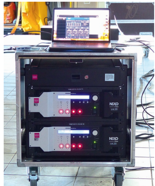
Nos deux amplis NXAmp alimentés de nos signaux de test. Aucun traitement n'a été ajouté pendant la phase d'écoute et de test.
